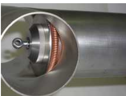
Hauptspannen das Formteil richtet sich aus
