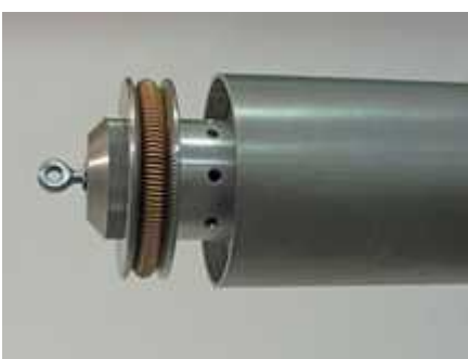
Vorspannen das Spanngerät richtet sich aus
