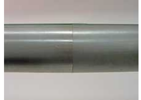
Hauptspannen Beide Rohre richten sich aus
